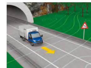
Der **Seitenwindassistent** des Daily stabilisiert das Fahrzeug bei starkem Seitenwind oder Böen, wie sie bei Brückenüberfahrten oder beim Überholen großer LKW auftreten können. Diese Funktion ist auch bei Fahrgestellen mit Aufbau erhältlich - eine Branchenpremiere.
