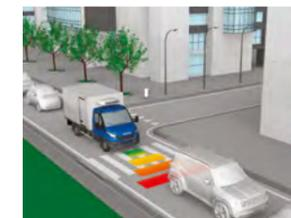
Aktivieren Sie bei dichtem Verkehr per Knopfdruck **den Stauassistenten** und der Daily bleibt im Stau automatisch stehen. Wenn das vorausfahrende Fahrzeug wieder anfährt, genügt eine leichte Berührung des Gaspedals und Ihr Daily setzt sich wieder in Bewegung. Stress in der Rush Hour gehört damit der Vergangenheit an!
