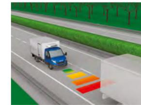
Mit dem **Adaptiven Abstandsregeltempomat** ACC können Sie das gewünschte Tempo sowie den Mindestabstand zum vorausfahrenden Fahrzeug einstellen. Wenn das Fahrzeug vor Ihnen langsamer wird, reduziert das System automatisch die Geschwindigkeit, um den gewählten Sicherheitsabstand einzuhalten.
