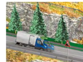
Mit einem beladenen Fahrzeug abschüssige Strecken hinunterzufahren, kann Nerven kosten. Der **Bergabfahrassistent** (HDC) des Daily für den Hinterradantrieb behält eine konstante Geschwindigkeit bei. Durch selbstständiges Abbremsen bringt er Sie langsam und sicher nach unten.
