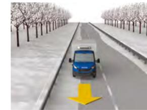
**Traction Plus** verteilt das Drehmoment so zwischen den Hinterrädern, dass Sie auf rutschigem Untergrund die Bodenhaftung behalten. Eine große Hilfe auf schwierigen Terrain wie Matsch, Sand oder Schnee. Erstmals in seiner Klasse ist dieses System beim Daily mit Heckantrieb erhältlich.
