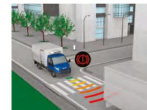
Das **Notbremssystem** (AEB) erkennt mögliche Kollisionen frühzeitig und bremst automatisch. Bis zu einer Geschwindigkeit von 50 km/h können Kollisionen so gänzlich verhindert und bei höheren Geschwindigkeiten deutlich gemildert werden. Bei starkem Verkehr und einer Geschwindigkeit ab 5 km/h hilft zusätzlich die **City Brake PRO** bei der Vermeidung von Kollisionen.
