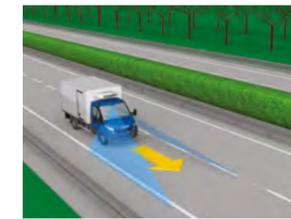
Der **proaktive Fahrspurüberwachungsassistent** LDWS des Daily hilft Ihnen, immer in der Spur zu bleiben. Bei unbeabsichtigtem Verlassen der Fahrspur steuert das System sanft zurück.
