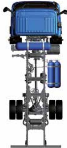
**Tank hinter dem Fahrerhaus mit freier linker Seite des Fahrgestells**
