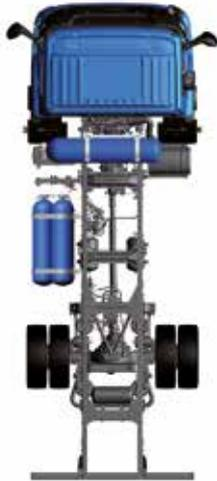
**Tank hinter dem Fahrerhaus mit freier rechter Seite des Fahrgestells**
